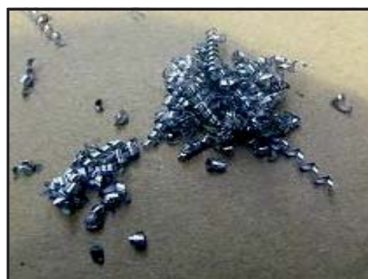
Strugotina odrezana s lomačem Chip cut with chipbreaker/ Späne mit Spanleitstufe
