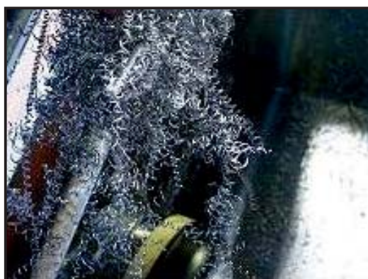
Strugotina odrezana bez lomača Chip cut without chipbreaker/ Späne ohne Spanleitstufe
